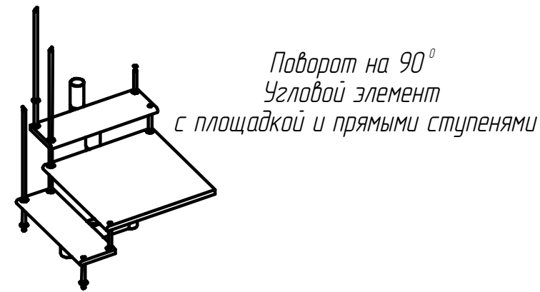
Схема расположения ступеней относительно опорных площадок металлического каркаса
