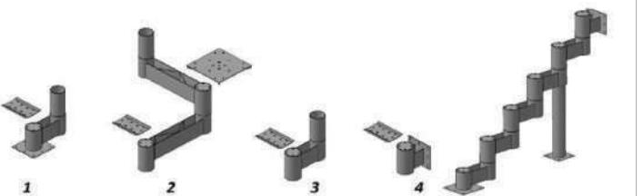
2. Первым всегда идет нижний элемент (№ 1). Его особенностью является металлическая пластина, позволяющая надежно закрепить элемент к полу нижнего этажа. К нижнему элементу, в зависимости от конфигурации лестницы, крепятся промежуточные и, при необходимости, угловые элементы.
